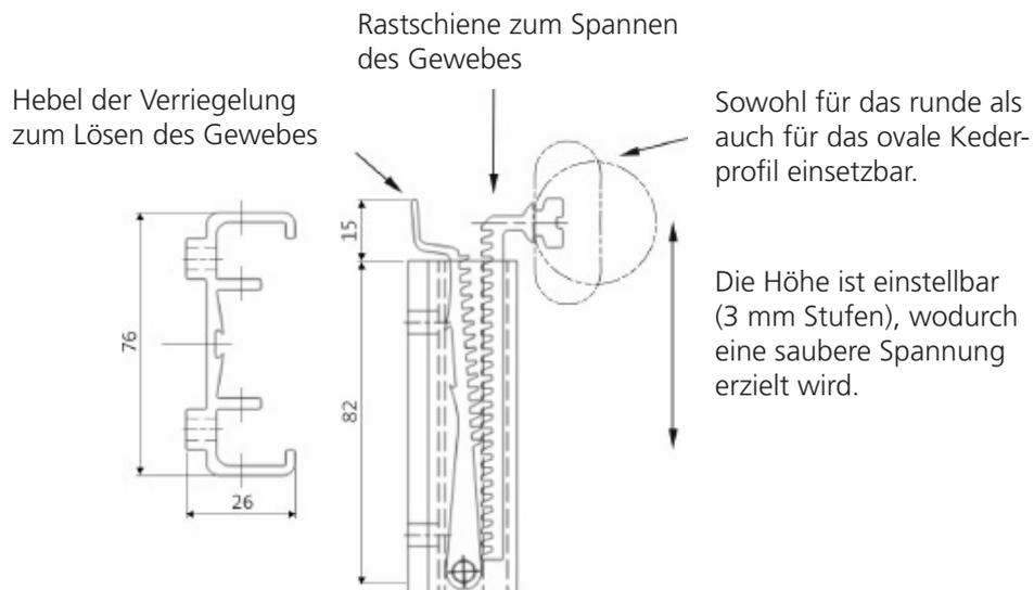
Vorder- und Rückansicht des Wandhalters am ovalen Kederprofil. Die Montage am runden Kederprofil erfolgt auf die gleiche Weise.
