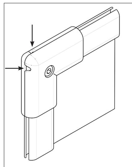
Spannen der Ecken durch Eindrehen des innenliegenden Gewindestifts.
