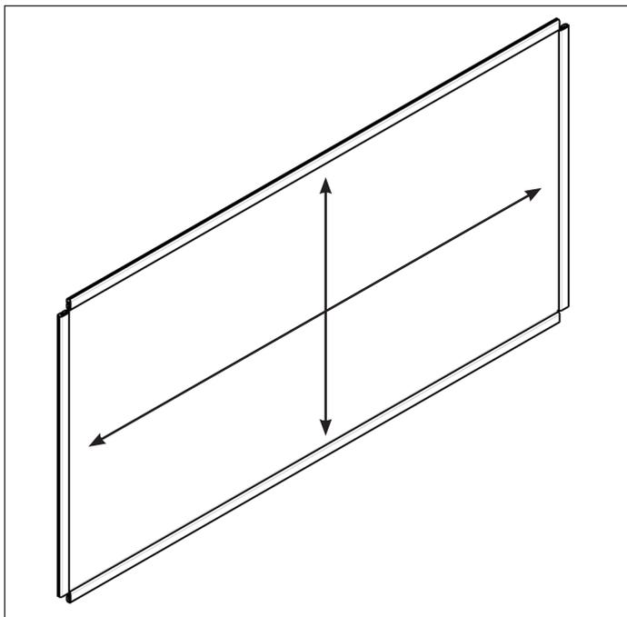
Wenn alle EPS.EASYQUICK-Wandhalter montiert sind, kann das Gewebe an allen vier Seiten gespannt werden. Dazu werden die einzelnen Kederschienen nach oben/unten bzw. nach Außen gezogen oder gedrückt.
