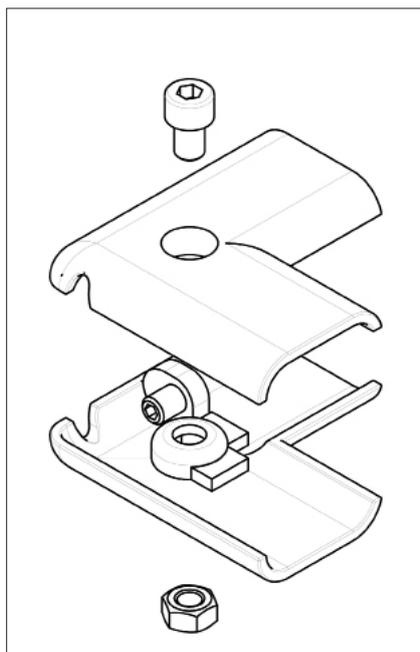
Trennen Sie die Oberschale der Spannecken von der Unterschale.
