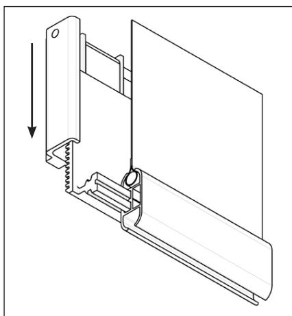
Die Verbindungsstücke in die Wandhalteteile einführen. Dazu Verriegelung nach hinten drücken und das Verbindungsstück von oben einschieben. Hierdurch wird das Gewebe leicht vorgespannt.
