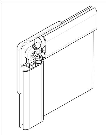
Führen Sie die Unterschale der Spannecken an die Verbindungsstellen der Kaderschienen.
