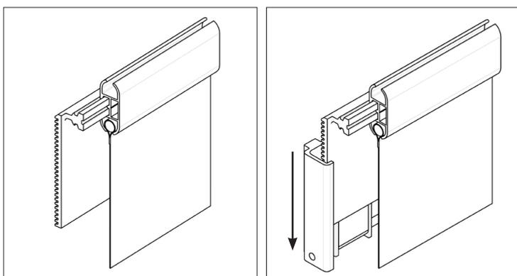
Alle Verbindungsstücke in den hinteren Kanal der jeweiligen Kederschiene schieben. Verbindungsstücke in das Halteteil des EPS.EASYQUICK einführen. Dazu Verriegelung nach hinten drücken und das Verbindungsstück **bündig** zur Oberkante des Halteteils einschieben.
