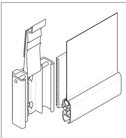
Verbindungsstücke ausrichten. Wandhalteteil zum Anzeichnen der Bohrlöcher seitlich neben Verbindungsstück halten und Bohrlöcher markieren. Darauf achten, dass das Verbindungsstück nach Montage der Halteteile ganz eingeschoben ist.
