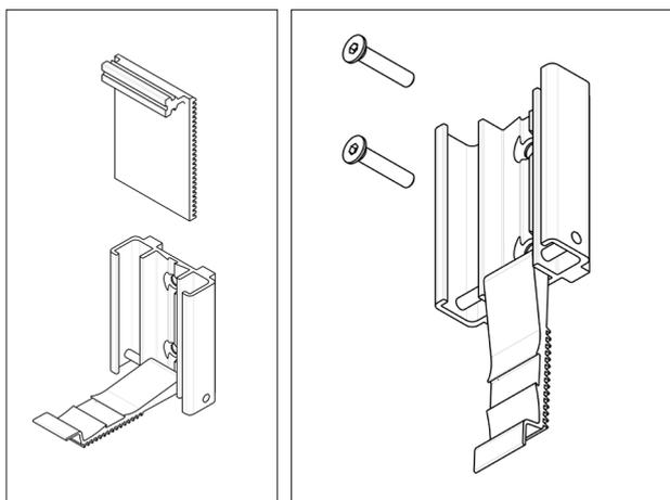
Das Verbindungsstück aus dem Wandhalteteil ziehen und die Verriegelung nach vorne umklappen, damit das Anzeichnen der Bohrlöcher für den EPS.EASYQUICK-Wandhalter erfolgen kann.
