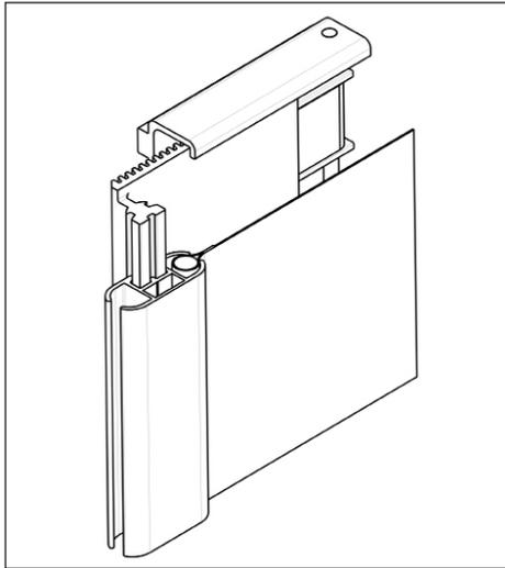
Schieben Sie die seitlichen Profilschienen über die seitlichen Keder des Gewebes und wiederholen Sie den zuvor beschriebenen Montageprozess des EPS.EASYQUICK-Wandhalters.
