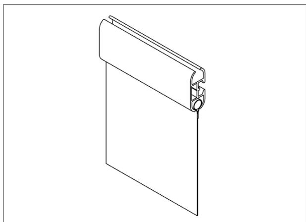
Den oberen Keder des Gewebes in den unteren Kanal der jeweiligen Kederschiene (EPS 7-001/7-005) schieben.
