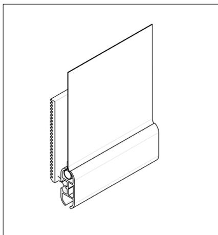
Die untere Kaderschiene über den unteren Keder des Gewebes schieben.
