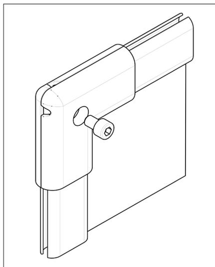
Verschrauben Sie die Oberschale mit der Unterschale.
