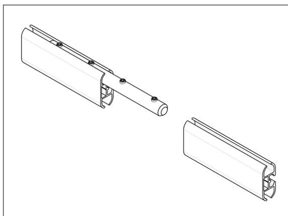
Bei längeren Abmessungen Kederschiene mit Längsverbinder EPS 7-060 verbinden.
