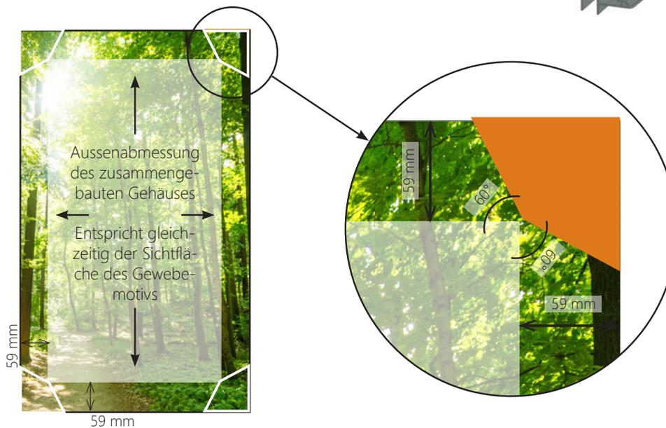
Addieren Sie zur Außenabmessung des Gehäuses umlaufend 59 mm.
