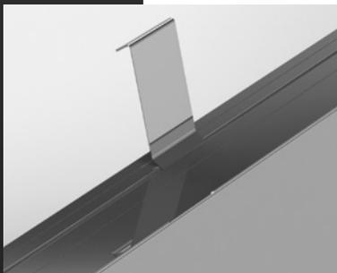
Das Abdeckprofil lässt sich mit Hilfe des Profillösers vom Profil lösen. Zum Lösen der Tuchhalter einem breiten Schraubenzieher verwenden, um den Tuchhalter im Spannprofil aushebeln, so dass dieser austrastet und zusammen mit dem Gewebe aus dem Spannprofil herausgenommen werden kann.
