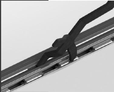
Der Nippel an der mittleren Spitze des Tuchhalterhebels wird in die Profilnut oberhalb des Spannkanals eingeführt. Durch Herunterdrücken der linken oder rechten Spitze des Tuchhalterhebels wird der Tuchhalter in den Zähnen des Spannkanals eingerastet und das Gewebe gespannt. Anschließend den Spannkanal mit dem Abdeckprofil schließen und mit Schrauben gegen unbeabsichtigtes Abspringen sichern.
