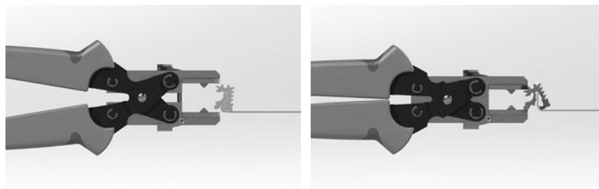
Um das Gewebe korrekt spannen zu können, wird der Tuchhalter einmal in Richtung der Sichtfläche umgeschlagen und dann in den Spannkanal des Profils geschoben!
