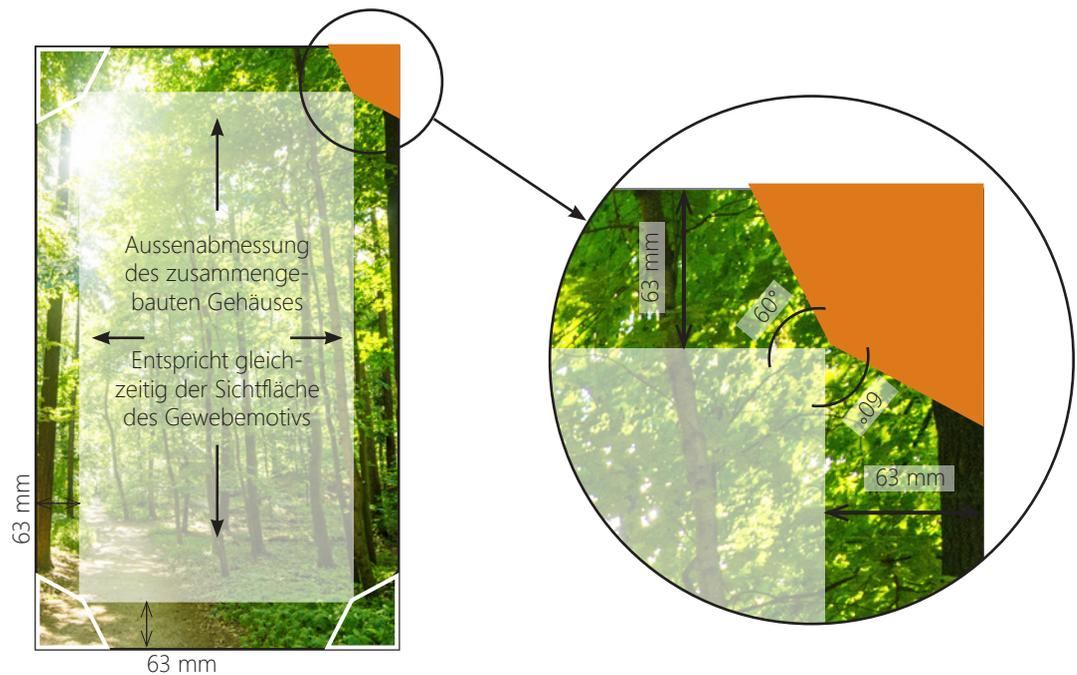
Addieren Sie zur Außenabmessung des Gehäuses umlaufend 63 mm.
