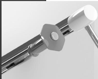
Um das Gewebe fest zu spannen, wird der Tuchhalter-Spanner wie ein Meißel auf den Tuchhalter angesetzt und mit dem Hammer tiefer ins Profil eingeschlagen. Bei kleinen und mittleren Formaten das Gewebe nicht zu fest spannen.
