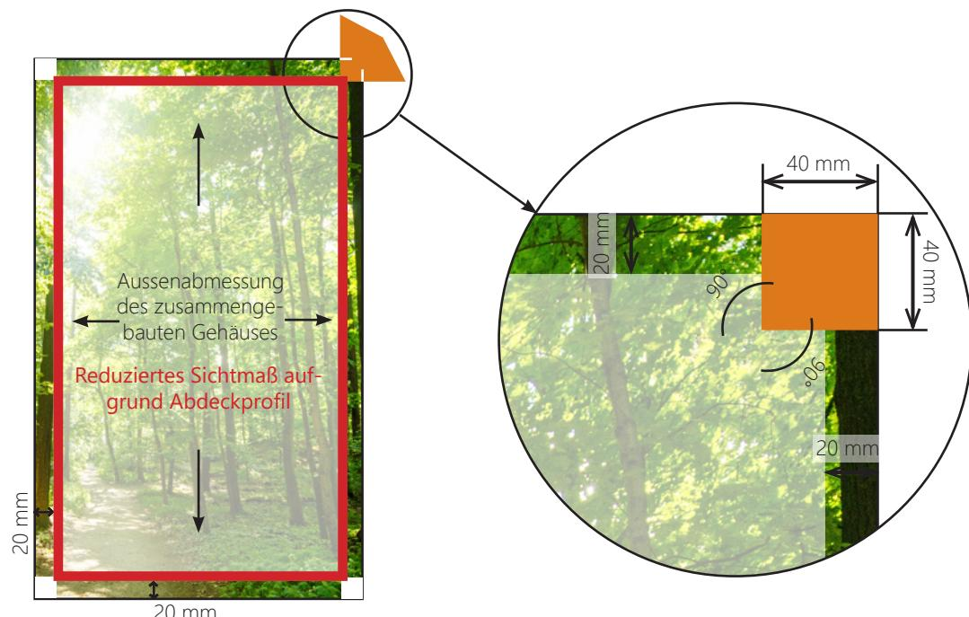
Addieren Sie zur Außenabmessung des Gehäuse umlaufend 20 mm.
