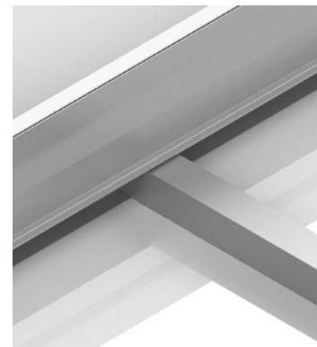
Aluminiumrohr EPS 12-055 ca. 5 mm kürzer als Rahmenformat zuschneiden und in entsprechende Nut stecken.
